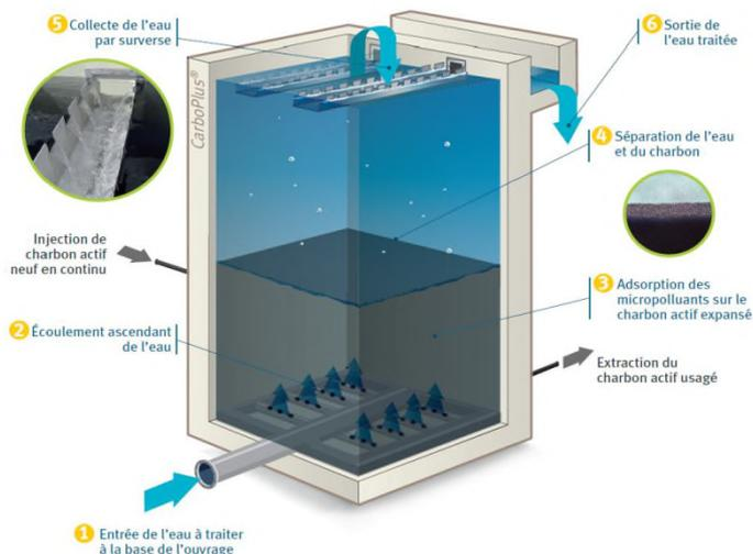
L'installation de traitement consistera en trois lits fluidisés de charbon actif micro-grains fonctionnant à flux ascendant, procédé simple d'exploitation et sans contraintes sécuritaires. Le bâtiment comportera également différents locaux et équipements nécessaires à ce procédé de traitement (silos et bennes pour le stockage du charbon actif, local électrique, galerie technique, etc.).
