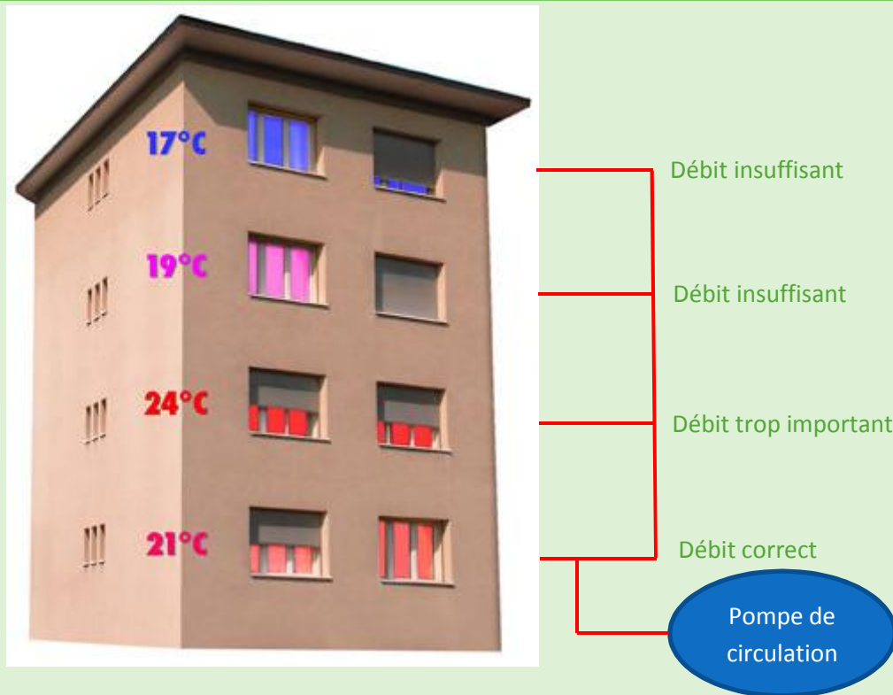
Figure 2 : Schéma d'une installation technique non-équilibrée
